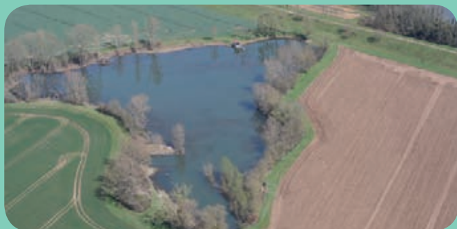
Trace de brèche par surverse, en aval du Bec d'Allier, rive gauche
