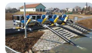
Exemple de pompes de refoulement d'inondation. Photos : BBA Pumps
