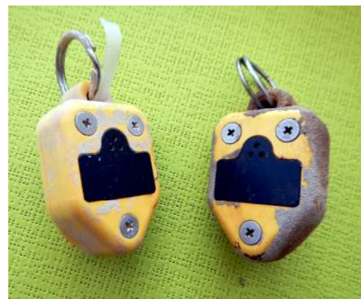
Figure 7 - Sondes fortement incrustées après une campagne de mesure à la goule et l'évent de Fousoubie. La sonde de gauche était positionnée à l'entrée du système à la base des puits dans la goule. Celle de droite était à l'émergence dans le siphon A de l'évent. Pour récupérer les données, un nettoyage important a été entrepris pour dégager les trois vis de contact.
