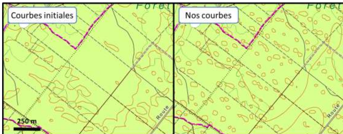
Figure 16. Courbes de niveau obtenues avec la méthode présentée, intégrées dans la carte topographique au 1 : 25k et comparées à la carte actuelle.
