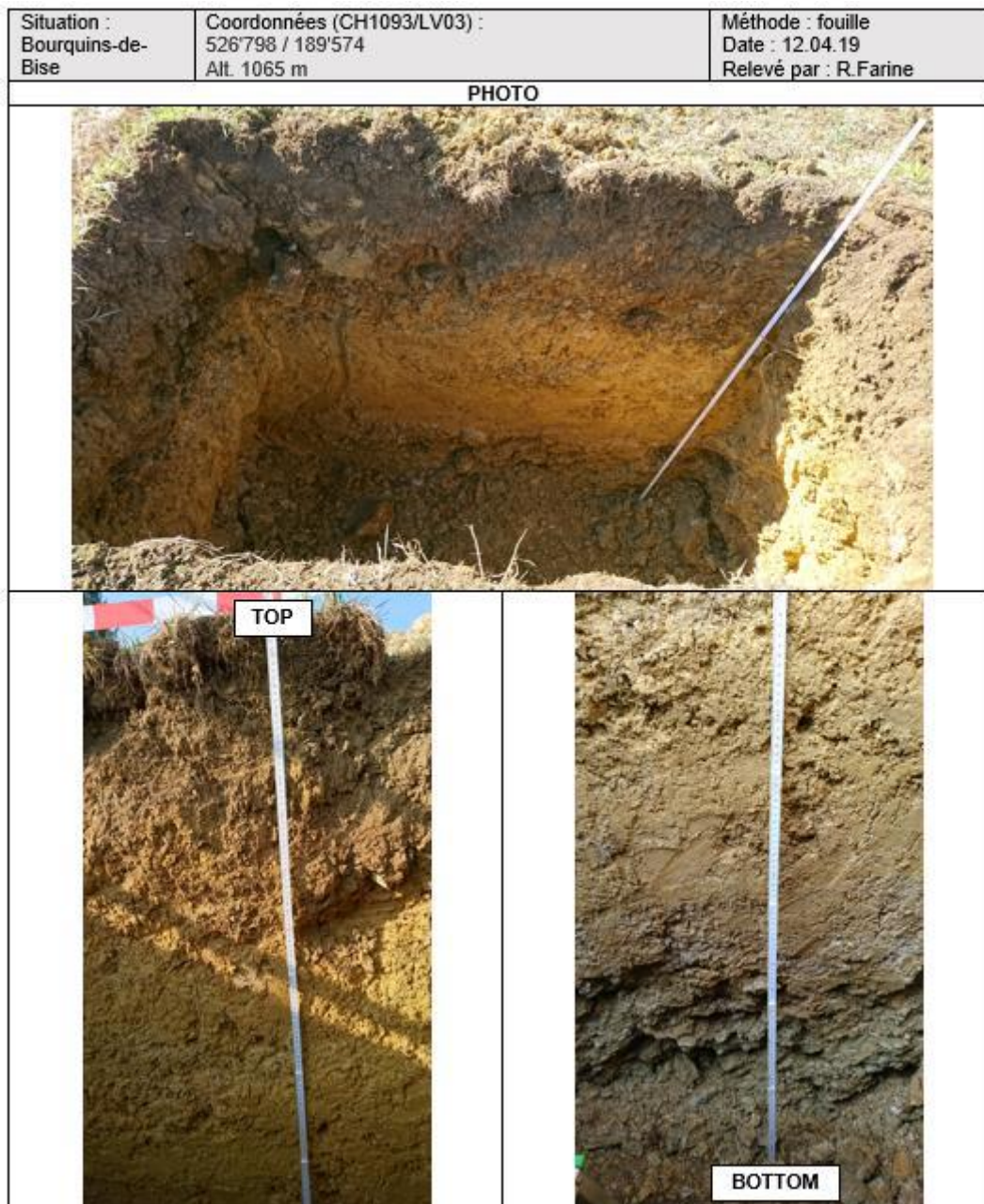
Annexe 11.5 : Données géologiques de la fouille F1 creusée pour l'essai de traçage du 16 avril 2019.
