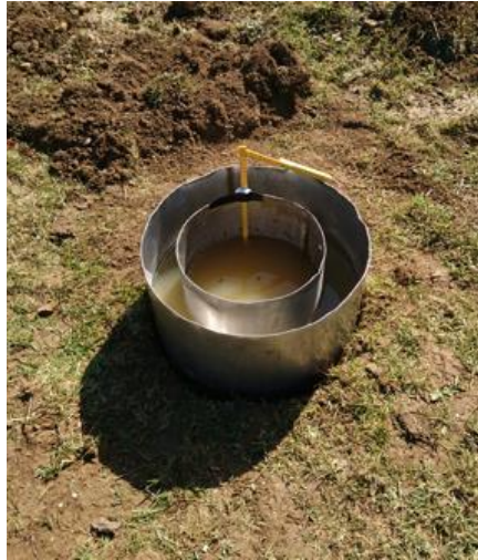
Figure 24: Infiltromètre à double anneau avec mètre pour la mesure du niveau d'eau.
