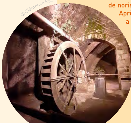
La roue actionnant les pompes.
