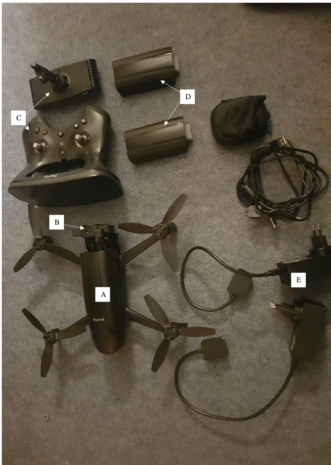
Matériel personnel : A = Drone / B = caméra thermique / C = Skycontroller / D = Batterie / E = alimentation
