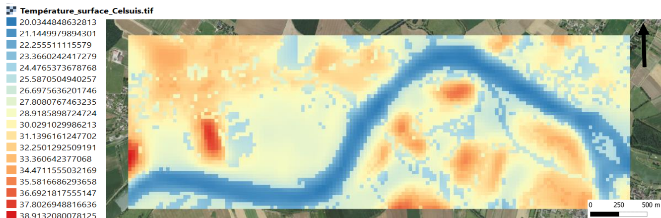
Figure 26 Cartographie thermique d'un tronçon d'un cours d'eau (La Saône) à large échelle.. Source : J.Grandvoinet
