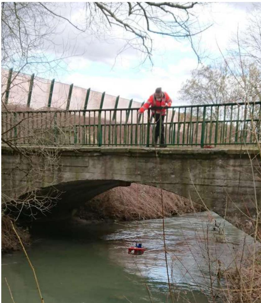
Figure 31 – Jaugeage de la Douce au StreamPro ADCP
