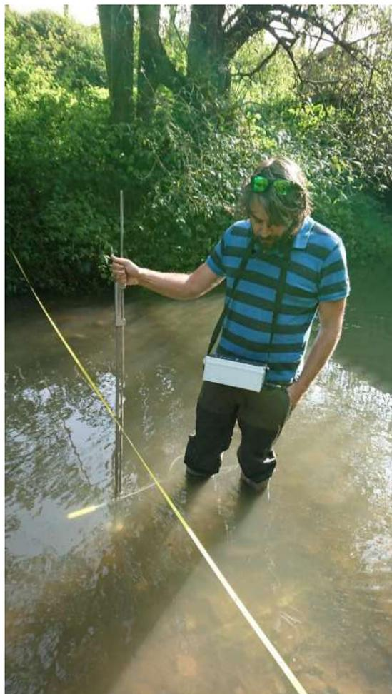
Figure 30 – Mesures du débit de la Douce au courantomètre
