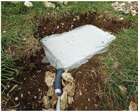
Figure 11 : Photo d'une plaque lysimétrique + géotextile (source: UFC)
