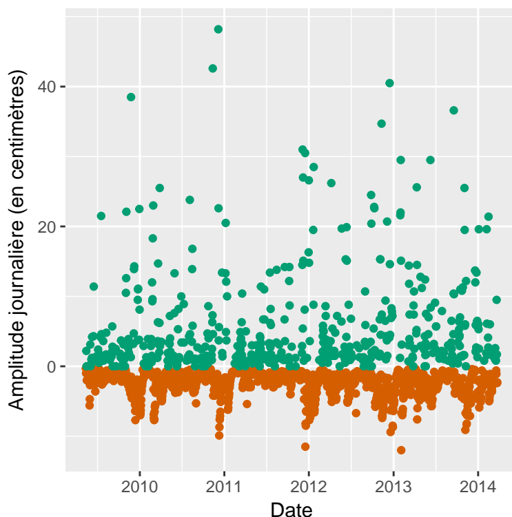
FIGURE 3.19 – Amplitudes journalières (en centimètres) et sens des variations du niveau du lac des Rousses (Vert : variation montante du niveau - Orange : variation descendante du niveau)
