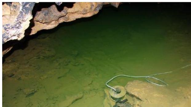
Fig. 25 : Fluorimètre et Uranine® à la Salle du Siphon, photo JJ Mépas.
